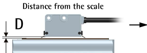
Figura 1 - Distanza montaggio sensore / banda
